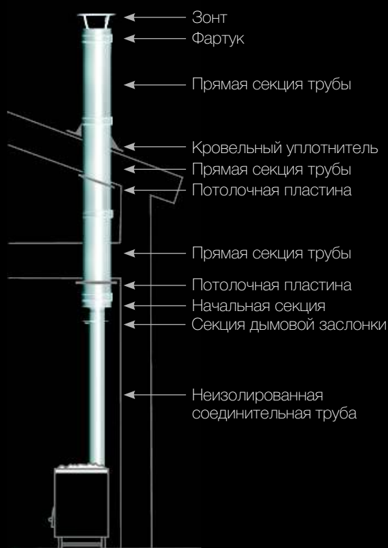
Монтаж с неизолированной соединительной трубой
