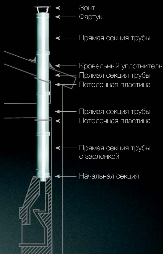
Монтаж сверху камина
