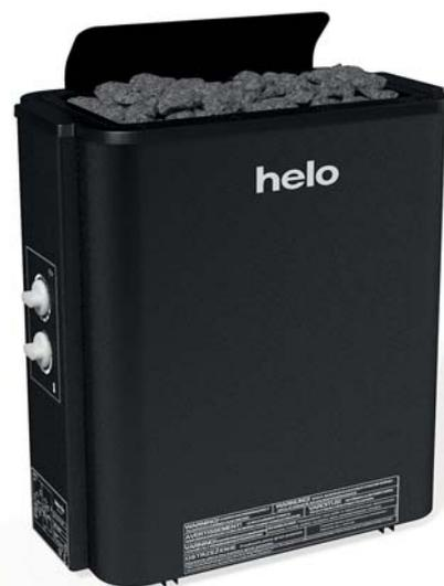
**КРАТКАЯ ИНФОРМАЦИЯ** | МОЩНОСТЬ: 4.5 - 9.0 кВт | РАЗМЕР САУНЫ: 3 - 13 м<sup>3</sup> | КАМНИ: 20, 28 или 35 кг | Ширина 475 x Высота 580 x Глубина 300 мм
