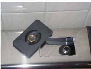
Пластмассовая крышка и трубка, используемые при процедурах удаления накипи
